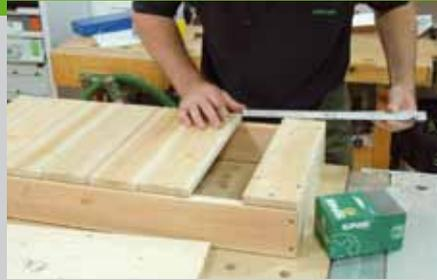
das Restmaß durch die Anzahl der Zwischenräume teilen. Zeichnen Sie auf dem Kasten die Position der Beine an und spannen Sie den Kasten zwischen den Beinen fest. Stecken Sie die beiden Traversen von oben in die Beine und die Stützen ein und legen Sie den Grillwagen auf die Seite. Bohren Sie die 8 mm Löcher und verschrauben Sie die Seiten
