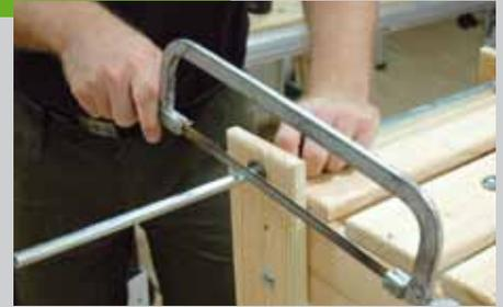
und den Kasten. Schieben Sie die Achse ein und schneiden Sie sie auf die passende Länge ab. Zwischen Rad und Holz kommt jeweils noch eine Unterlegscheibe M12. Wenn Sie eine Hakenreling am Grillwagen haben wollen, müssen Sie in die beiden Traversen auf einer Seite jeweils ein 15 mm Loch bohren und einen 15 mm Rundstab mit einbauen.
