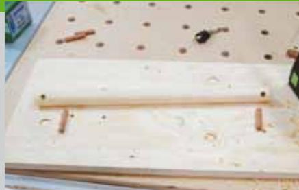
In den Küchenrollenhalter wird auf beiden Seiten jeweils ein 8 mm Loch für die Dübel (8 x 50) gebohrt. Einer dieser beiden Dübel wird fest eingeklebt, der andere ist zum Herausnehmen, wenn die Küchenrolle getauscht werden muss. Wenn Sie in der oberen Ablage ein Loch (26 mm) bohren und am langen Bein
