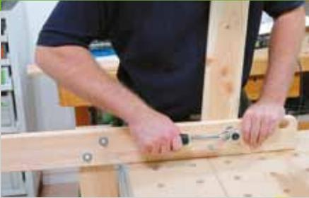
3. Die beiden Seitenteile werden mit Schlossschrauben miteinander verschraubt. Verschrauben Sie die langen und die kurzen Seiten (Pos. 9 + 10) des Kastens miteinander und befestigen Sie von unten die Bodenbretter (Pos. 11). Der Abstand zwischen den Brettern wird folgendermaßen errechnet: alle Bretter aneinander auf den Kasten legen und
