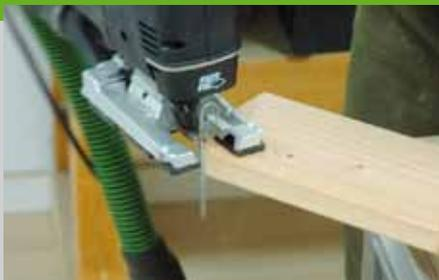
2. Am Endbrett der unteren Ablage (Pos. 6), an den beiden Außenbrettern der oberen Ablage (Pos. 8) und an den Enden der Auflagebretter werden die Ecken großzügig abgerundet (R = 25 mm). Am Besten sägen Sie die Rundungen mit der Stichsäge und schleifen diese anschließend mit einem Bandschleifer oder Handschleifklotz. Für den Griff und für den Küchenrollenhalter
