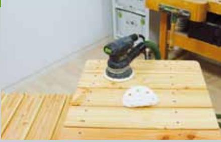
6. Schleifen Sie die Flächen und alle rauen Stellen mit einem Exzenter-schleifer oder einem Handschleifklotz. Der letzte Schliff sollte mit Körnung P180 erfolgen. Für die Behandlung der Oberfläche wird die Achse noch einmal ausgebaut. Streichen Sie die Flächen mit einem wasserfesten Holzöl oder einer Lasur. Um wirklich glatte Flächen
