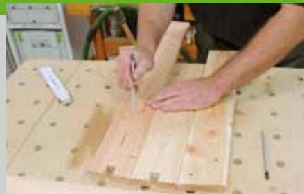
werden Löcher (d = 30 mm) in die Auflagebretter gebohrt. Runden Sie alle sichtbaren Kanten ab. Die spätere Position der Bretter wird mit einem Schreinerdreieck gekennzeichnet. Zeichnen Sie die Positionen der Kreuzungspunkte zwischen den einzelnen Brettern an. Markieren Sie auch gleich die Stellen, an denen die 8 mm Löcher für die Schlossschrauben gebohrt
