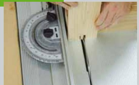
sollten Sie hinter die Werkstücke zusätzlich einen Klotz an den Anschlag der Kreissäge spannen. Dadurch kippeln die Beine beim Schieben nicht und die Größe der Anschlagfläche wird erhöht. Alternativ können die Ausschnitte auch mit einer Stichsäge gesägt werden. Unten in die kurzen Beine wird jeweils ein Loch (12 mm) für die Achse gebohrt.
