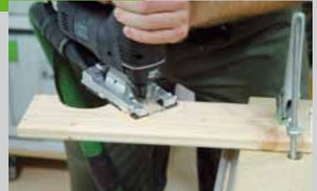
Auf den Kasten kann ein Flaschenhalter aufgeschraubt werden. Dafür wird in zwei der Bodenbretter jeweils ein Halbkreis mit der Stichsäge ausgeschnitten und mit einem Handschleifklotz oder einem Bandschleifer geschliffen. Dann müssen Sie die Kanten noch runden und schon können Sie den Flaschenhalter von oben anschrauben.
