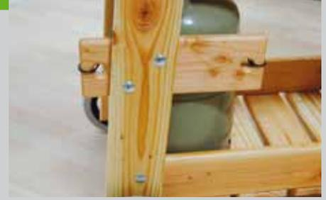
Falls Sie einen Grill mit einer großen Gasflasche benutzen, müssen Sie im oberen Bereich der Flasche noch ein Brett an das hintere Bein anbringen. In dieses Brett werden zwei Löcher gebohrt, durch die die Flasche mit einem Expander befestigt werden kann.
