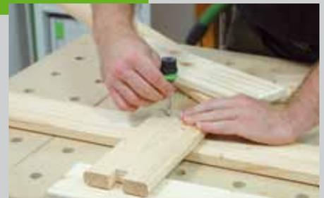
werden müssen. Bohren Sie zunächst die Löcher in die Positionen 1, 2, und 4. Um gerade zu bohren sollten Sie eine Dübelbohrschablone oder einen Bohrständer verwenden. Spannen Sie jetzt die Teile an den Kreuzungspunkten fest und markieren Sie mit einem 8 mm Bohrer die Lochmittelpunkte. Bohren Sie anschließend die restlichen Löcher für die Gewindeschrauben.
