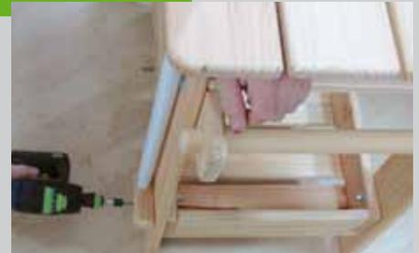
einen Holzklötz mit dem gleichen Loch festschrauben, haben Sie einen Halter für einen Sonnenschirm, der nur noch von oben eingeschoben werden muss. Je nach Gasgrill sollten Sie noch Befestigungen auf die untere Auflage schrauben, dass der Grill während des Transports nicht verrutschen kann.
