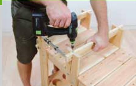
Beim Festschrauben der restlichen Bretter werden als Abstandshalter 6 mm dicke Holzstückchen dazwischengelegt. Setzen Sie die beiden Traverse von oben in die Schlitze ein. Bohren Sie in jeder Überplattung von oben ein Loch vor und schrauben Sie die Traversen fest. Jetzt können auch die oberen Auflagebretter festgeschraubt werden.
