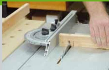
In die Traversen, die langen Beine (Pos. 1) und in die Stützen (Pos. 4) werden mit der Kreissäge oder der Stichsäge Schlitz gesägt, um die Teile zusammenstecken zu können. Die Schlitzbreite entspricht der Materialdicke, die Höhe der Schlitz ist die halbe Breite der Traversen. Die entstehende Verbindung ist eine so genannte Kreuzüberplattung. Beim Zusägen der Beine
