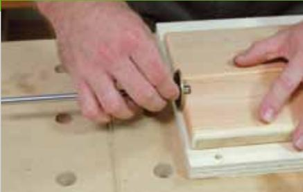
4. In die Auflagen (Pos. 6 + 7 + 8) werden die Löcher für die Schrauben vorgebohrt. Um das Anzeichnen der Löcher zu beschleunigen, können Sie ein Streichmaß einsetzen. Schrauben Sie zunächst die kurzen unteren Auflagen (Pos. 7) zwischen den Beinen und den Stützen fest.
