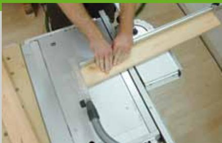
1. Sägen Sie die Bretter auf das in der Materialliste angegebene Maß ab. Die Beine (Pos. 1 + 2) werden an beiden Enden schräg (5 Grad) abgesägt. Die beiden Traversen werden schmaler gesägt. Die Breite ist so festgelegt, dass Sie aus einem Brett zwei Traversen heraussägen können. Bei Längsschnitten sollten Sie in die Kreissäge ein größeres Sägeblatt einbauen.
