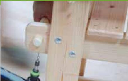
5. Schneiden Sie den Handgriff (Pos. 12) und den Rundstab für den Küchenrollenhalter (Pos. 13) ab. Die Schnittkanten werden großzügig abgerundet. Stecken Sie den Handgriff in die Löcher ein und schrauben Sie ihn von unten mit zwei Schrauben fest.
